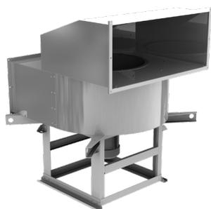
Вентиляторы радиальные пристенные ВР-П ДУ (ДУВ) предназначены для использования в стационарных системах вытяжной противодымной вентиляции в случае отсутствия возможности размещения вентилятора непосредственно на кровле здания (при неровной или стеклянной крыше). Данные вентиляторы также могут быть использованы при совмещенном режиме работы (дымоудаление / общеобменная вентиляция).
